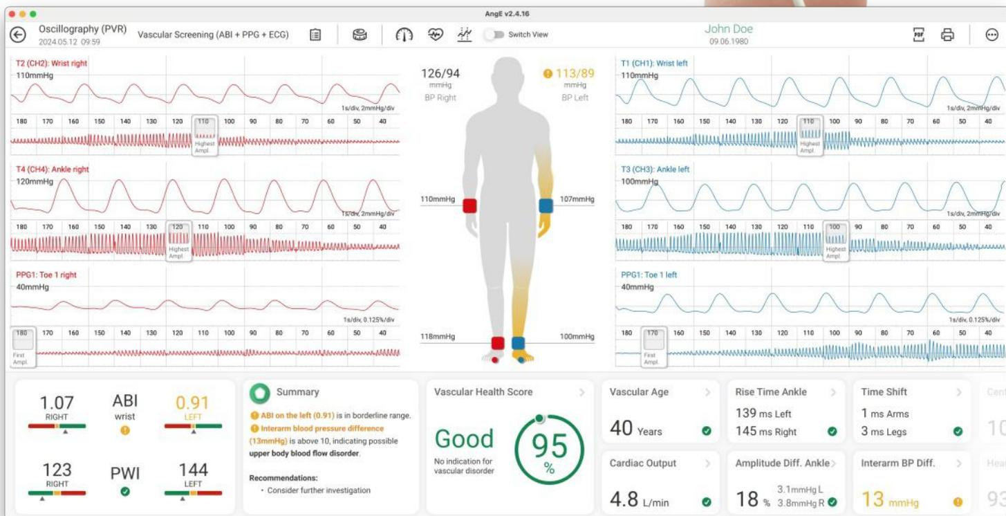
6-Kanal simultane Pulswellenaufzeichnung an Handgelenken, Fesseln und Zehen unter Anwendung der TOPP-Methode (Tissue Optical Perfusion Pressure).
